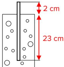
Befestigen Sie die Gewindestange in einem für die Situation geeigneten Beton.
